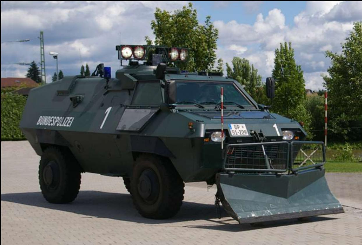
Das Einzelstück U 10000 wurde mit einem Fahrgestell vom Baumuster 435, das normalerweise als Panzerwagen TM170 unterwegs ist, aufgebaut.
